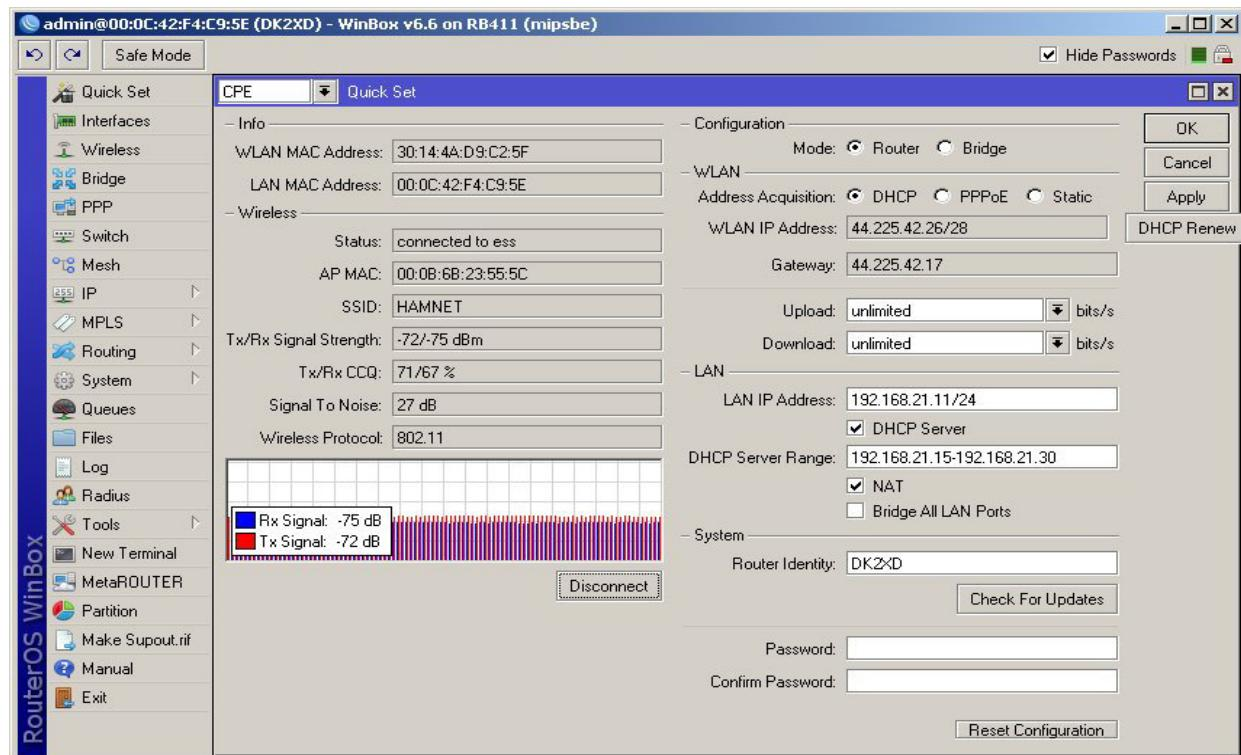
Zum Ausrichten der Antenne ist das „Quick Set“ Fenster gut geeignet, weil alle Daten incl. der Feldstärke übersichtlich dargestellt sind. Wenn alles funktioniert kann unter „Files“ ein Backup der Konfiguration gemacht werden. Das Backup File kann allerdings nur auf den eigenen Router zurückgespielt werden.
