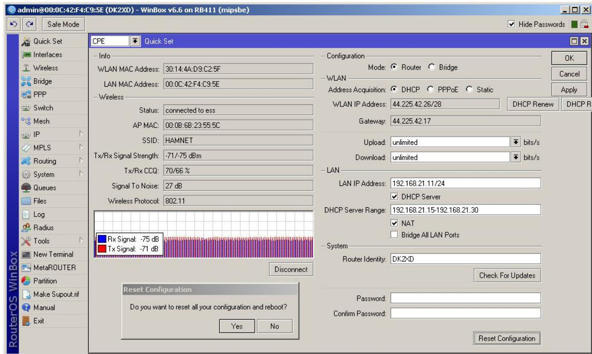
„Quick Set“ auswählen, „Reset Configuration“ rechts unten drücken und mit Yes bestätigen. Dadurch werden alle vorherigen Daten gelöscht, anschließend wird automatisch die Verbindung unterbrochen und ein Neustart durchgeführt.
