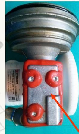
LNB aus dem Kunststoffgehäuse nehmen und den Deckel abschrauben. Anschliessend den Quarz gegen einen mit 26.0 MHz tauschen. Deckel zu, fertig.
