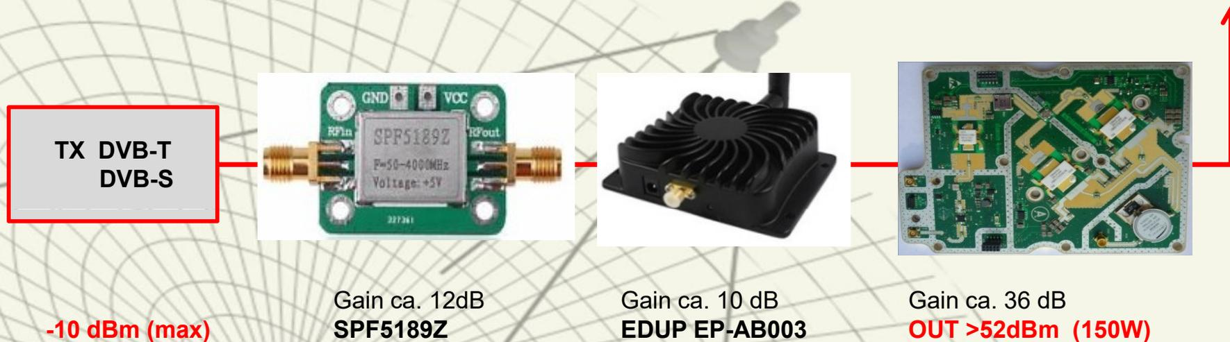
zusammen mit dem SPF5189Z und dem EDUP EP-AB003 kann die PA im 13cm AFU Bereich voll angesteuert werden.
